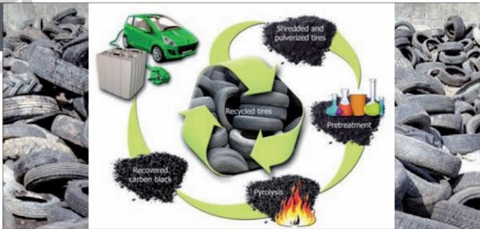
чего при помощи пиролиза, нагрева до высокой температуры без доступа кислорода, получают сажу.
