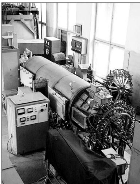
энергетических компрессионных плазменных потоков превосходят все существующие в настоящее время типы плазменных ускорителей. Такие потоки уже используются для фундаментальных исследований течения замагниченной плазмы в электромагнитных полях различной конфигурации (что является новым разделом плазмодинамики). Они необходимы также для решения ряда задач управляемого термоядерного синтеза (инжекция плазмы в создаваемые магнитные ловушки), для ускорения
