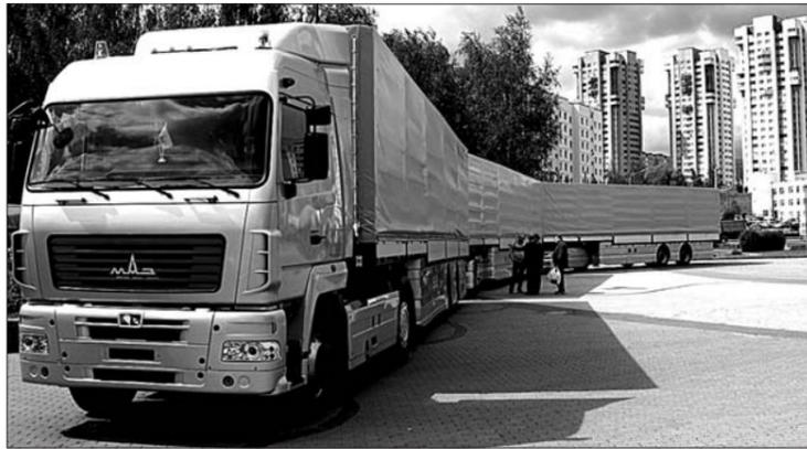
мощью пульта дистанционного управления. То есть при разгрузке-погрузке любой из грузовых модулей можно отцепить и дистанционно переместить, не запуская основной двигатель.
