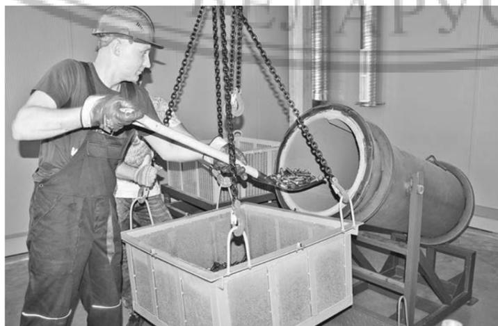
крытия за счет перехода атомов цинка в паровую фазу и проникновения в железную подложку. Как и при горячем цинковании, образуется железозинковый сплав сложной фазовой структуры. Образование такого покрытия возможно только при температурах 300–450°C и в замкнутом пространстве реторт или муфель, заполненных цинкуемыми деталями и цинкосодержащей порошковой смесью.
