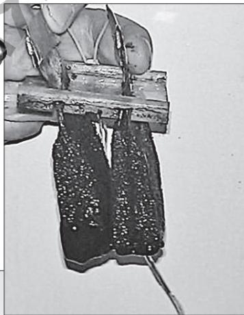
обладает новизной и конкурентоспособностью, а также технологическими преимуществами. Ученые имеют на выходе неокисленную, структурно совершенную и, следовательно, высокопроводящую и химически стойкую пористую массу на основе расширенного графита.
